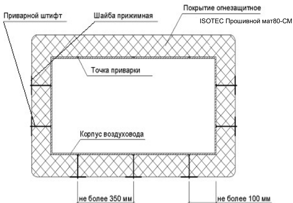
Рис.4. Принципиальная схема расположения матов по периметру воздуховода
